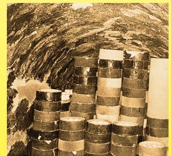
Forno tradizionale cinese a drago (龙窑 Long Yao), bocca di alimentazione e metodo di riempimento con porcellane elettriche (collezione privata)
